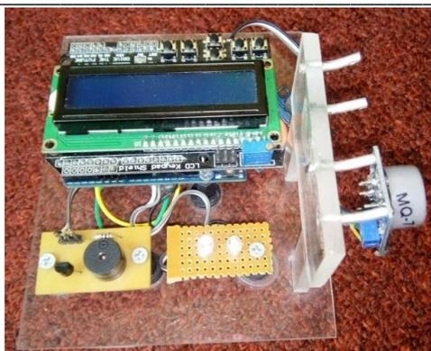
Gambar .5. Prototype perangkat deteksi gas CO
