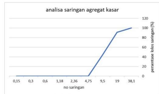
Berdasarkan nilai MHB yang didapat dari hasil pengujian yaitu 6,64 telah memenuhi standar SII 0052 MHB untuk agregat kasar
