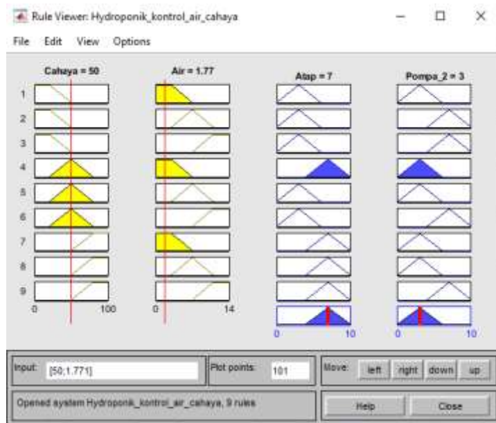
Gambar 14. Simulasi Proses Penentuan Kondisi Output Dengan Matlab
