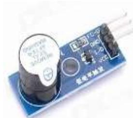
**Gambar 9.** Simbol *Buzzer* dan Bentuk Fisik *Buzzer*
