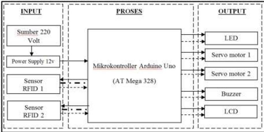
Gambar 6 Blok Diagram
