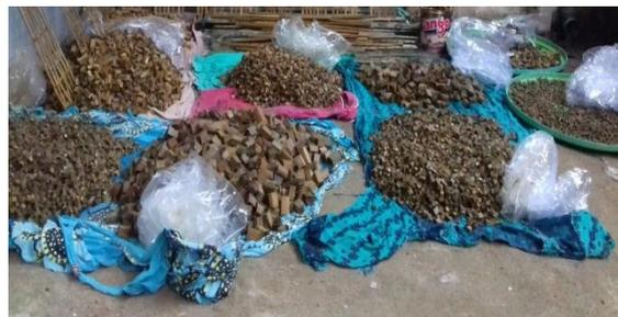
**Gambar 1 :** Potongan agregat bambu berdasarkan ukuran
