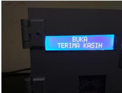
**Gambar 10.** Tampak keterangan pada LCD apabila kartu tag terbaca oleh RFID reader
