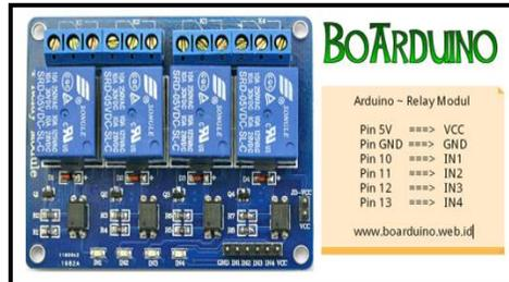
Gambar 4. Modul Relay Untuk Mikrokontroler
